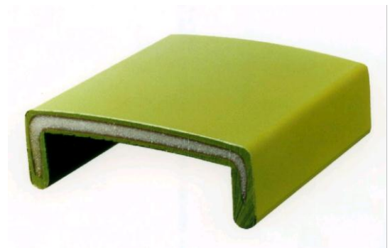
「お茶入りベンチ」の断面図 (表層に茶配合樹脂、芯材に使用済み白色トレイ)
